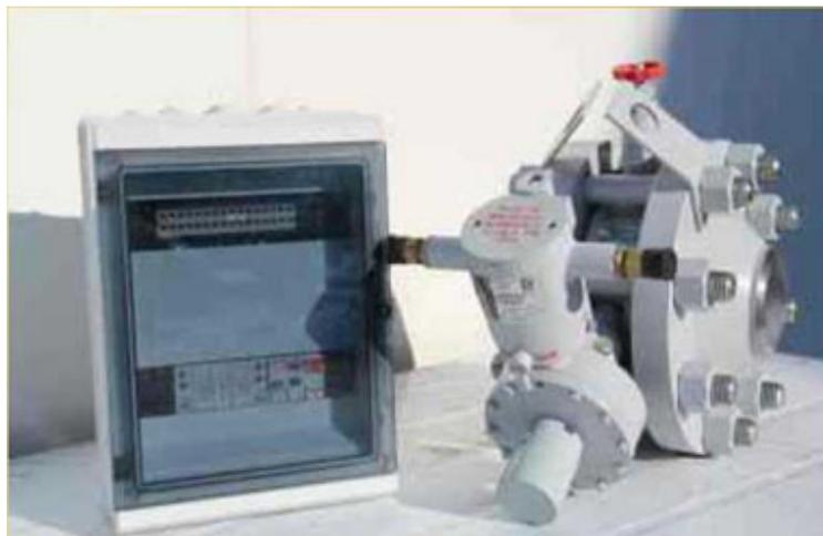
Взрывозащищенный отсекатель скважины ТС — ОС — 2М1 с электроприводом предназначен для автоматического перекрытия трубопровода, отходящего от скважины, в случае отклонения давления в трубопроводе от рабочего (превышение или уменьшение) и предотвращения выхода из строя устьевого оборудования.
