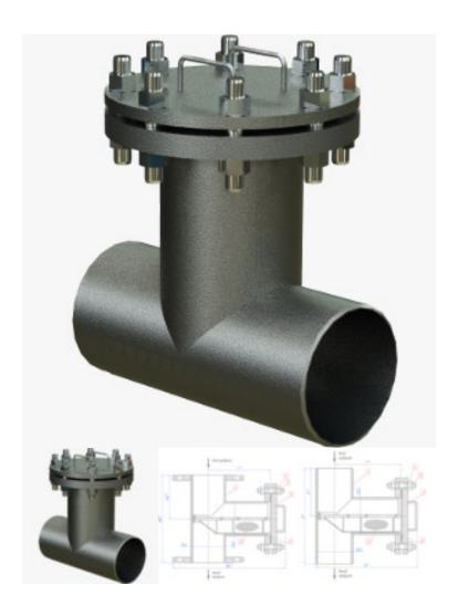
Сетчатые фильтры ФС-IV изготавливаются по ТММ-11-2003. Устанавливаются вертикально. Устанавливаются на всасывающих линиях насосов для защиты их от окалины, грязи и посторонних предметов, после монтажа или ремонта трубопровода. Применяются для нефтепродуктов, газа, воды и кислот.
