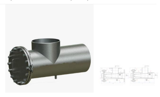
Сетчатые фильтры ФС-V производятся по ТММ-11-2003. Устанавливаются горизонтально. Устанавливаются на всасывающих линиях насосов для защиты их от окалины, грязи и посторонних предметов, после монтажа или ремонта трубопровода. Применяются для нефтепродуктов, газа, воды и кислот.
